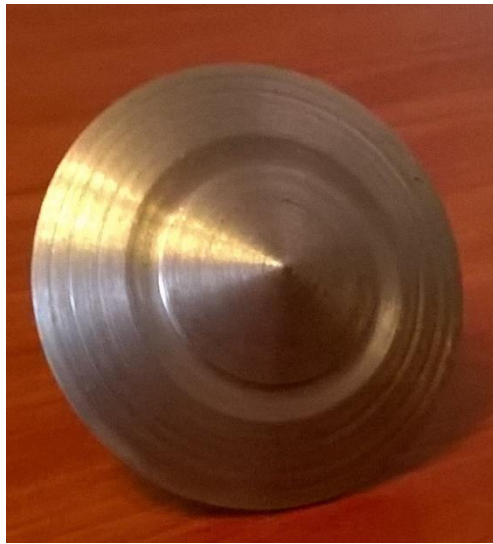
Рисунок 3.3 - Дефлектор с канавкой шириной 3 мм.
